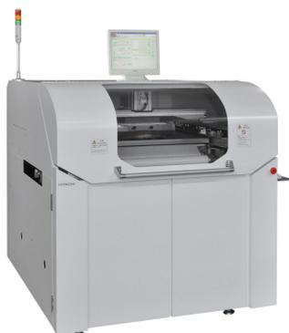
此次，株式会社日立工业设备技术（执行董事、社长：東原 敏昭）开发了以大尺寸印刷基板（Min50×50mm～Max620×510mm）为对象的新型锡膏印刷机“HP-07”及“HP-08”。本机在大型基板方面也体现了本公司的特长—高精度印刷，同时实现了与小型基板不相上下的周期时间。并且，我们正在以标准机种的价位提供着高级机种的功能。
