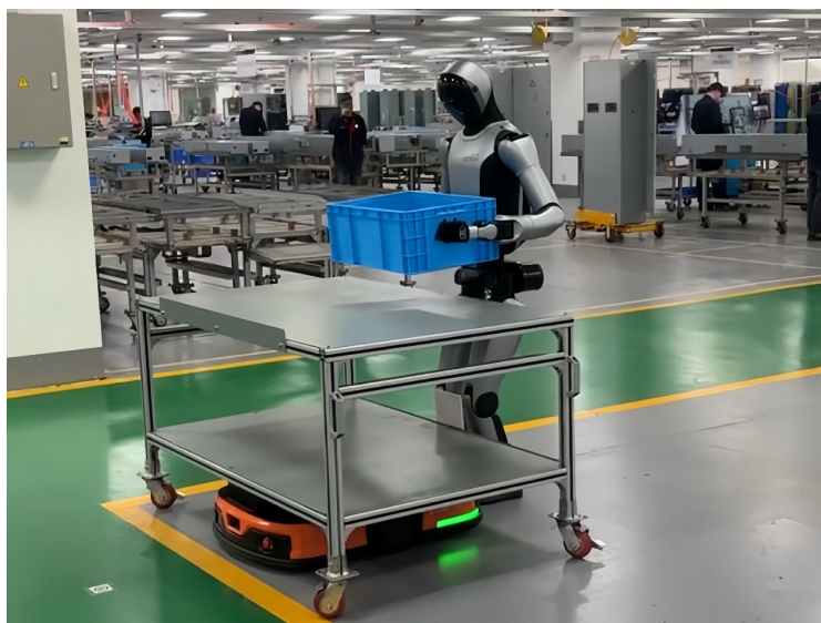
优必选人形机器人在日立电梯车间进行现场作业测试
